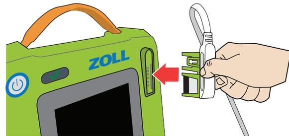
Stecken Sie den CPR Uni-padz-Stecker in den AED 3-Elektrodenanschluss.
