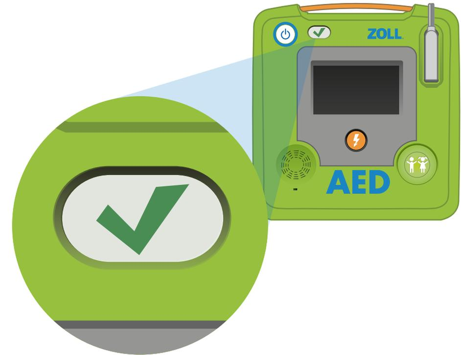
Der AED 3 meldet den erfolgreichen Abschluss des Selbsttests mit der Sprachausgabe „Gerät OK“ bzw. mit dem grünen Symbol auf der Statusanzeige. Der AED 3 ist jetzt betriebsbereit. Konsultieren Sie bei Fragen die Bedienungsanleitung im Dokumentenordner.
